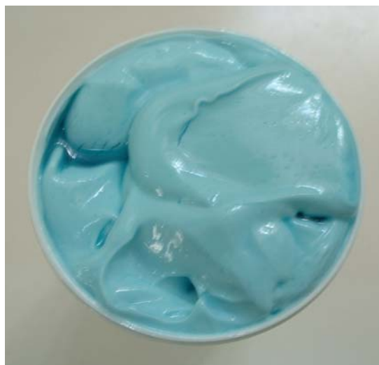
Figura 29. Vista frontal a tamaño real de la emulsión A/O elaborada con el sistema de agitación mecánica, a los 12 días de haber sido preparada.
