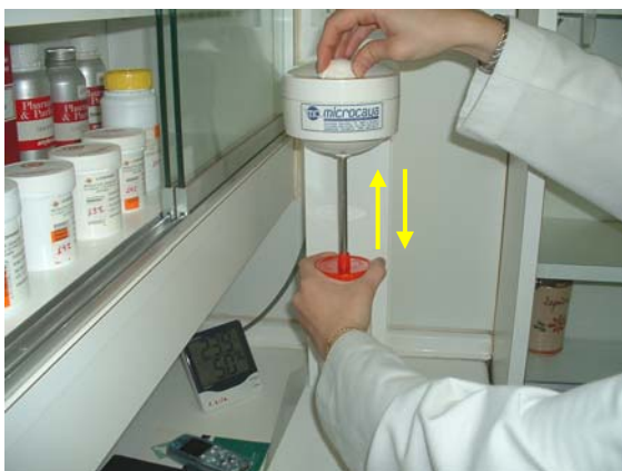
Figura 14. Movimiento del envase durante la agitación.
