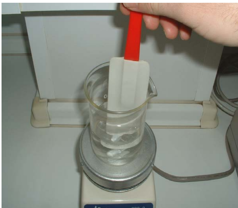
Figura 1. Situación de la espátula para evitar la formación de turbulencia, empleando el agitador magnético.
