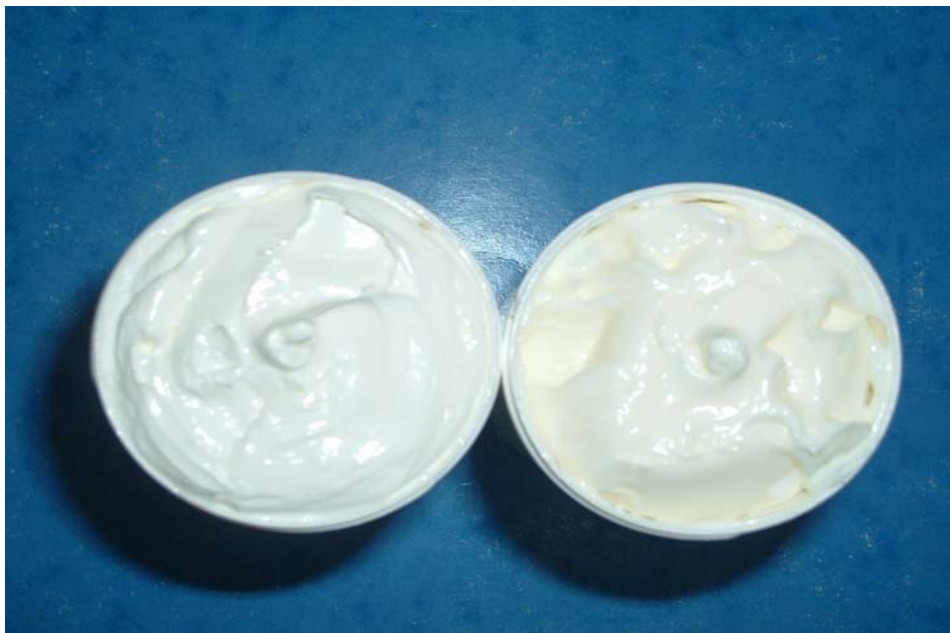
Figura 40. Vista frontal de la emulsión manual (derecha) y de la emulsión elaborada con el sistema agitador mecánico (izquierda).
