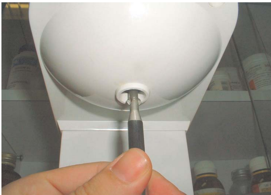
Figura 6. Acoplamiento de la varilla en el aparato agitador.
