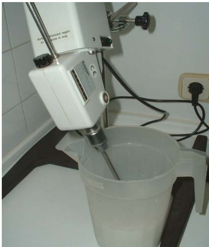
Figura 2. Agitador Heildolph® con la varilla situada en forma inclinada respecto al recipiente de elaboración, para evitar la formación de turbulencia.
